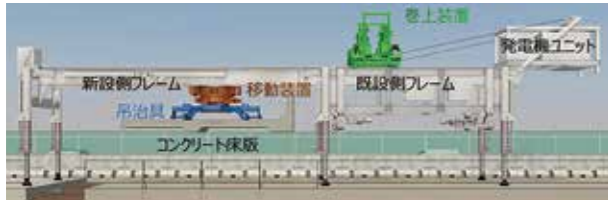
本取替機は新設側・既設側フレームの2つの大型部材とこれらに付設する各ユニットで構成
